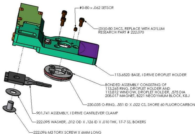
Figure 7.1.: iDrive Droplet Holder
