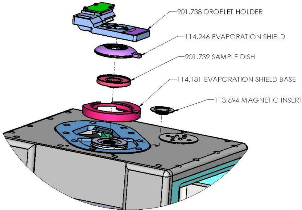
Figure 6.1.: Droplet Cantilever Holder nomenclature.
